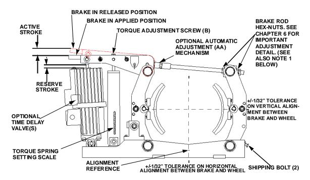
NOTE 1: INSTEAD OF HEX-NUTS, A FACTORY INSTALLED PIN FASTENS BRAKE ROD TO PIVOT BLOCK ON AUTO-ADJUST (AA) BRAKES UNDER 16" DIAMETER.
