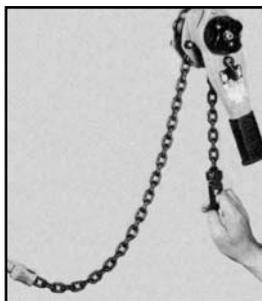
**Photo 1 - Palier tendeur de chaîne relâchée**
