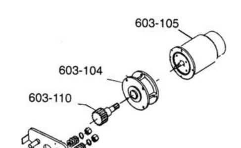
FIGURE 6 1/8-2 AND 3 TON RAILSTAR **MOTOR DRIVEN TROLLEY** EXPLODED VIEW
